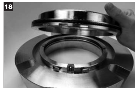
18 Retire el adaptador de la brida. Retire el O-Ring del adaptador (Z) y deséchelo. Aparte el adaptador.
